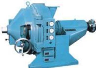
Das DD® Upgrade Package wird von Valmet für Ihre Beloit-Jones DD® Refiner (OEM für alle Beloit-Jones Produkte) angeboten. Der Einsatz dieses Produktes verbessert die Refiningergebnisse, erhöht die Lebensdauer der Platten und verringert den Energie- und Wasserverbrauch sowie die Wartungskosten, wodurch weniger Stillstände erforderlich sind und die Kontrollierbarkeit der Maschinen steigt.
